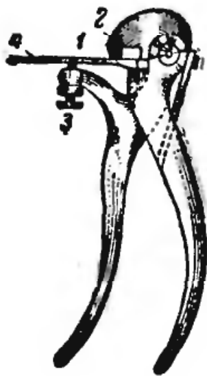
Рис. 15. Клещи для разводки: 1, 2 — губки; 3 — упорный винт, регулирующий величину отклонения зубьев; 4 — полотно пилы.
