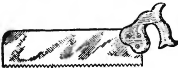
Рис. 9. Ножовка с широким полотном: ширина полотна 40—100 мм; длина 300—500 мм; число зубьев 40—70 шт. на 100 мм длины. Ручка ножовки должна быть выше зубьев не менее чем на 40—50 мм.
