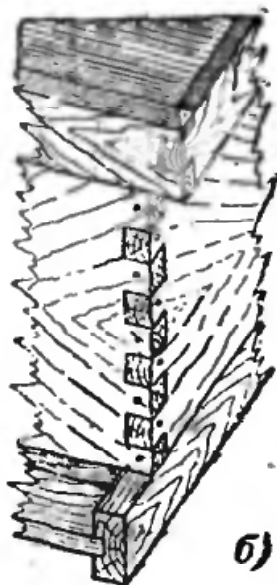
Рис. 68. Корпус одностенного 10-рамочного улья Рута: а — корпус с отнятой боковой стенкой; высота корпуса (с фальцами) 250 мм; б — угол корпуса с частью крыши и дна в выполнении американских заводов.
