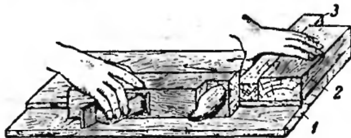
Рис. 72. Приспособление для зачистки торцов в брусках.
