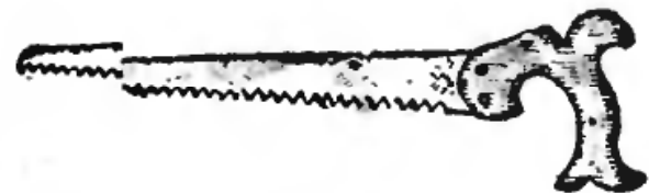
Рис. 10. Ножовка с узким полотном: ширина полотна у ручки 20—40 мм; ширина у свободного конца 6—15 мм; длина 300—500 мм; число зубьев 30—50 шт. на 100 мм длины.
