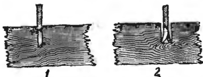
Рис. 12. Виды пропила: 1—зубья пилы не разведены; полотно пилы зажимается боковыми стенками пропила, и, вследствие трения боковых граней пропила, пила нагревается и заедает; 2—зубья пилы разведены; ширина пропила больше толщины полотна пилы; трение боковых граней отсутствует; пила не нагревается и не заедает.
